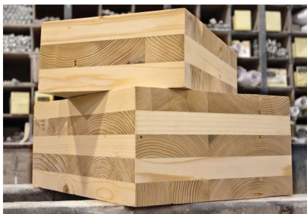
Bild 1. Drei- und fünflagige Brettsperrholzbauteile [6]
